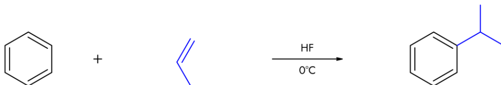
Rysunek 5. Alkirowanie benzenu za pomocą propenu w obecności kwasu fluorowodorowego.
