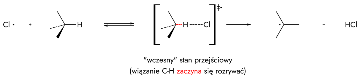
Rysunek 4. Etap 2a reakcji chlorowania alkanu ukazujący proces tworzenia "wczesnego" stanu przejściowego.
