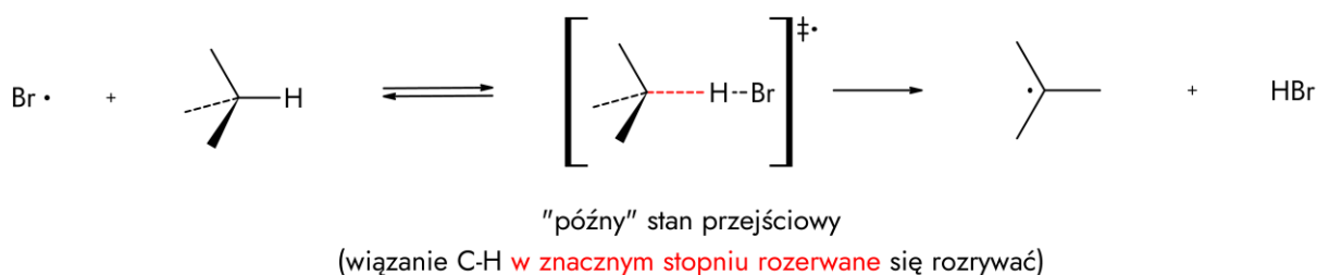
Rysunek 5. Etap 2a reakcji bromowania alkanu ukazujący proces tworzenia "późnego" stanu przejściowego.
